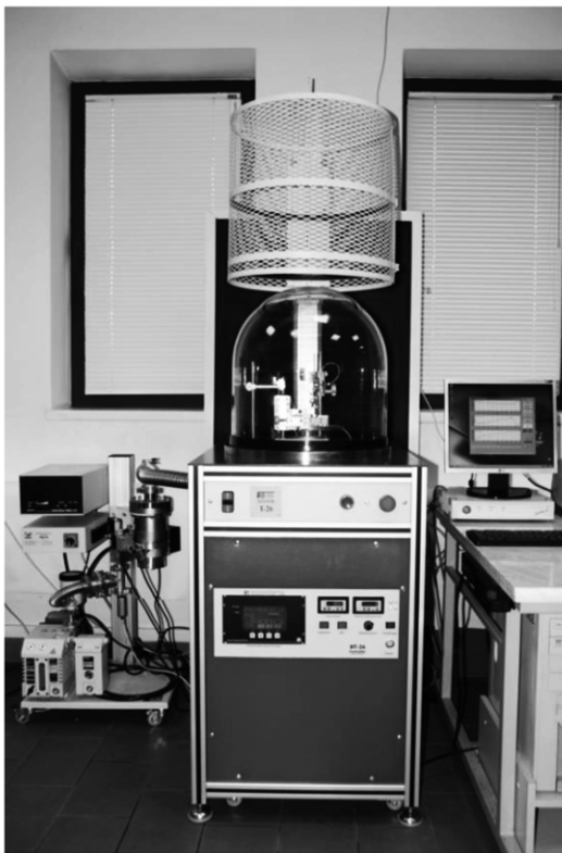
Fig. 1. Testing device and test conditions: a) view of the device; b) schematic representation of the friction joint Rys. 1. Urządzenie badawcze i warunki badań: a) widok urządzenia; b) schemat węzła tarcia
